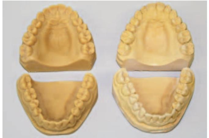
Abb. 2 Ein generativ gefertigtes Dentalmodell (links, FotoTec SL.A) und ein traditionell gefertigtes Gipsmodell.
