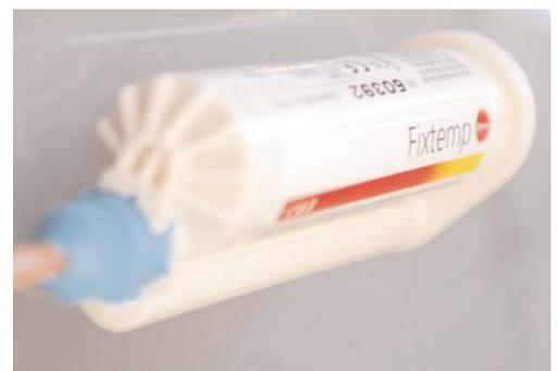
Abb. 4 Der autopolymerisierende Kunststoff Fixtemp der Firma Dreve, Unna.
